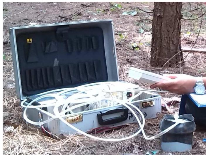
شکل ۲- دستگاه قابل حمل اندازه‌گیری تنفس خاک (CO<sub>2</sub>-Port) ساخت آلمان
