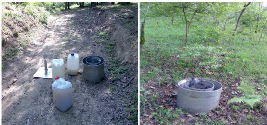
شکل ۲- اندازه‌گیری مقادیر نفوذپذیری در جنگل و مسیر چوبکشی
